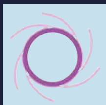
Шести-лепестковая укладка баллона
